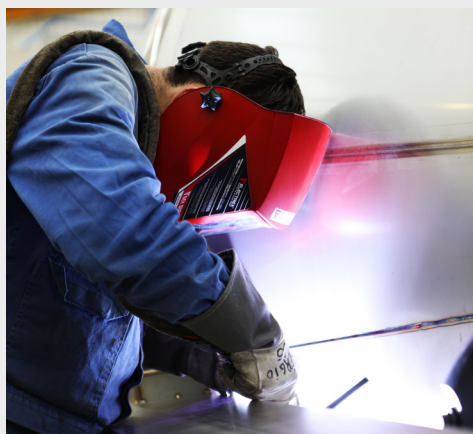
▶ Soldadura TIG com ignição do arco de alta frequência com o seu retificador.
